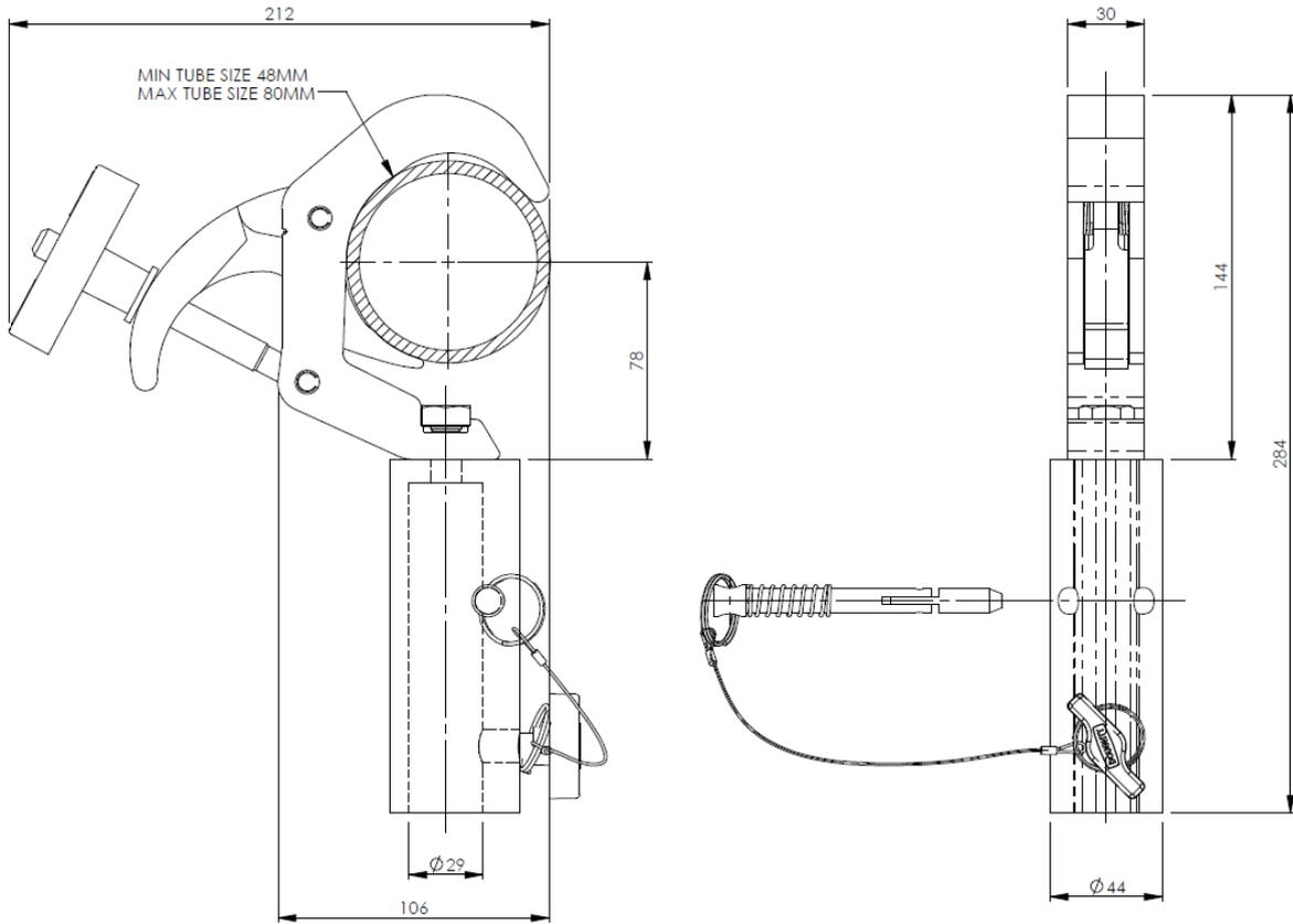
**TITAN QUICK TRIGGER TV CLAMP (NOT CE MARKED)**
